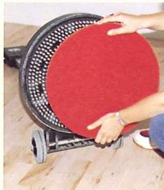
Fest paden på føringsskiven, pass på at paden er mest mulig sentrert på føringsskiven, så unngår du ubalanse når du kjører. Maskinen kan nå reises opp, og er klar til bruk.
